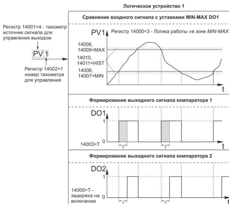
Рисунок. 3.2 – Принцип работы дискретных выходов модуля RIO-RPM3
