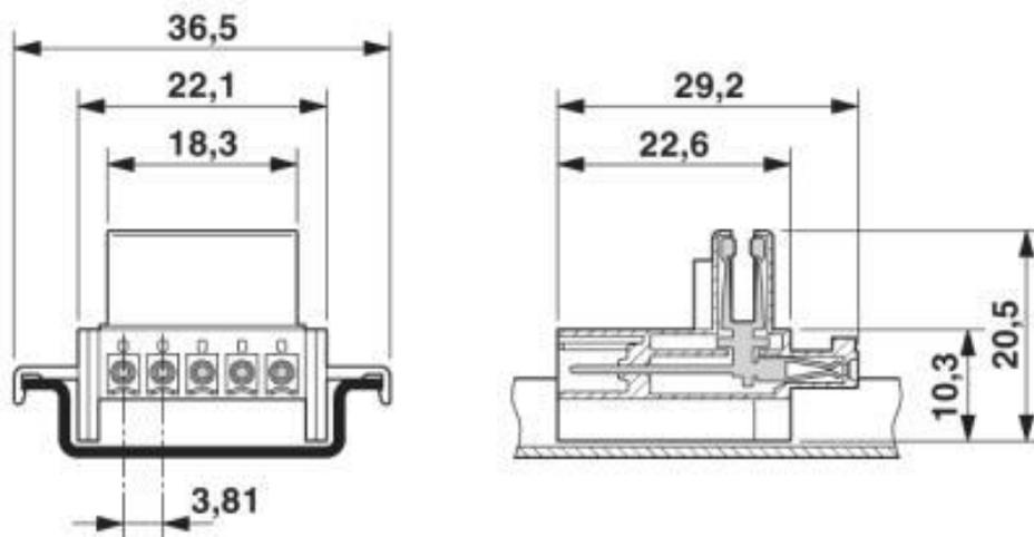
Рисунок А.2 - Габаритные размеры разъема питания РШД-5
