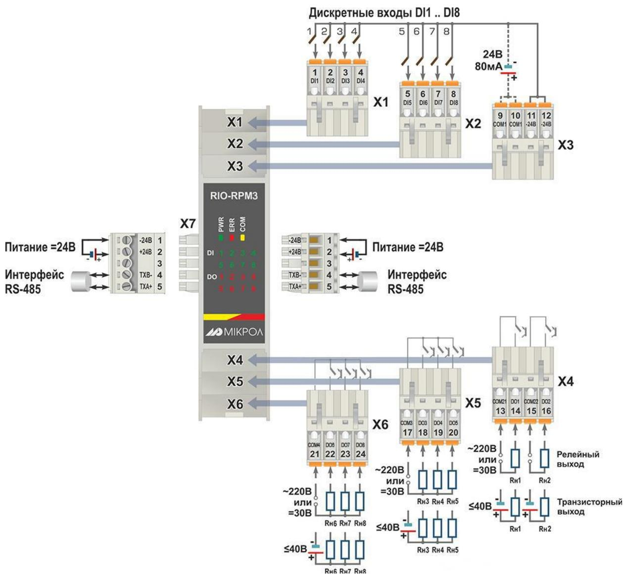
Рисунок Б.1 – Нумерация клемм и сигналы модуля тахометров RIO-RPM3 для исполнения дискретных входов с общим минусом (однополярное исполнение):
