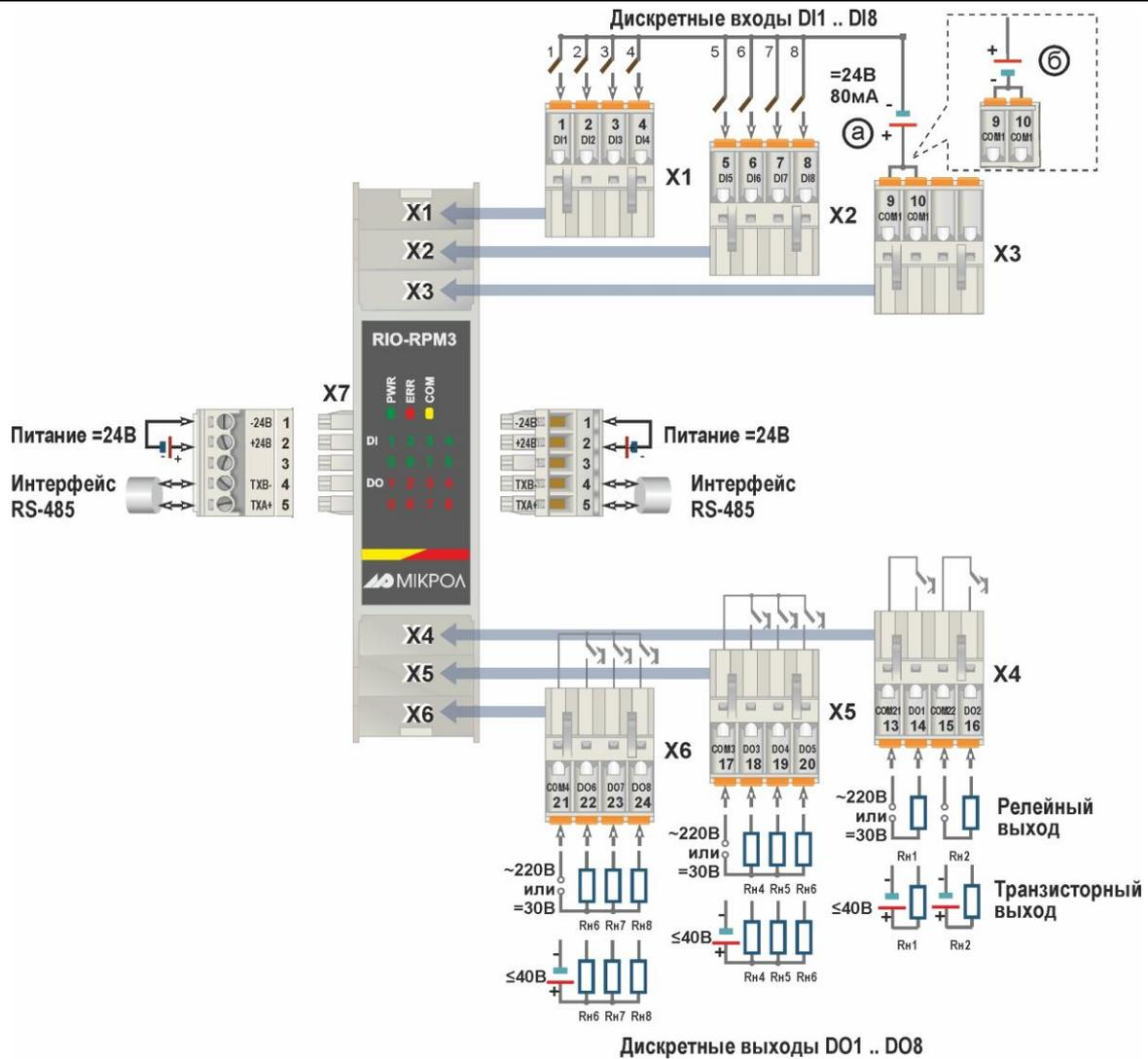
Рисунок Б.2 – Нумерация клемм и сигналы модуля тахометров RIO-RPM3 для исполнения дискретных входов с общим любой полярности (двухполярное исполнение):
