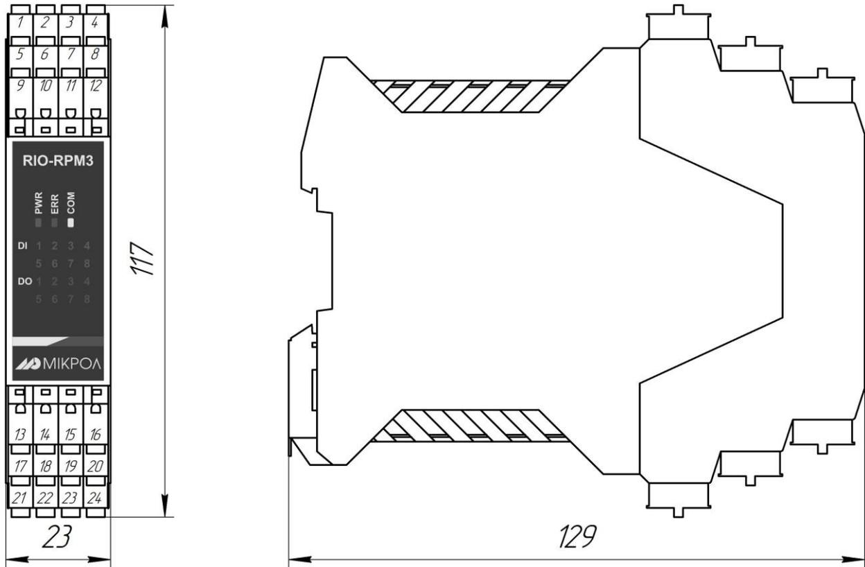
Рисунок А.1 - Габаритные размеры RIO-RPM3
