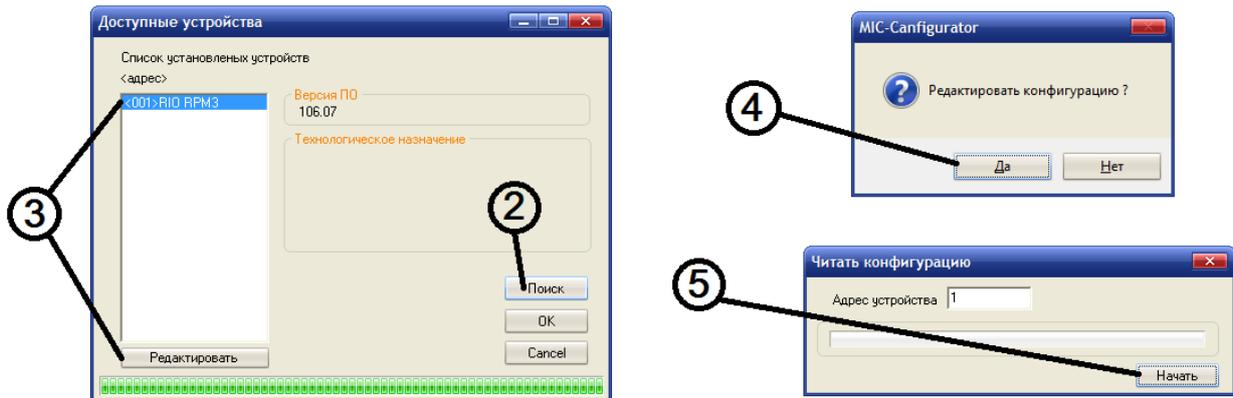
Рисунок 4.3 – Поиск доступных устройств и считывание параметров модуля
