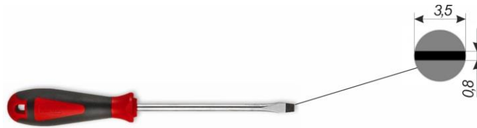
Рисунок 3.4 – Розміри шліца викрутки типу SL 0,8x3.5
