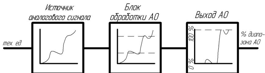
Рисунок 3.6 – Работа блока аналогового вывода в режиме ретрансмиссии
