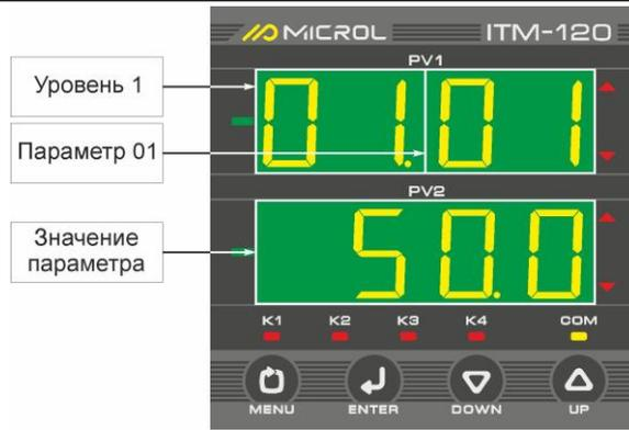
Рисунок 4.3 - Индикация значения параметров конфигурации и их номеров
