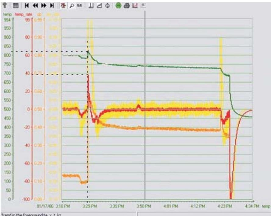
РИС. 3. ТРЕНДЫ SCADA-СИСТЕМЫ ВО ВРЕМЯ ОСТАНОВКИ ГПА
