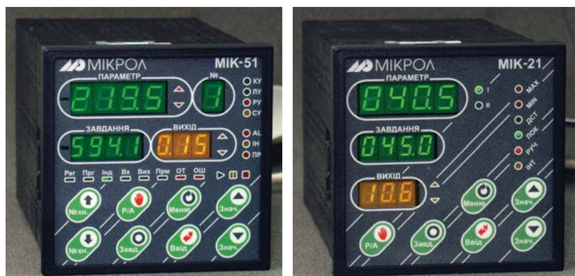
Рис. 1. Гибкость внутренней структуры и легко перекалибруемые входы/выходы регуляторов МИК-21 (справа) и контроллеров МИК-51 (слева) позволяют легко адаптировать аппаратные средства под конкретный объект управления
