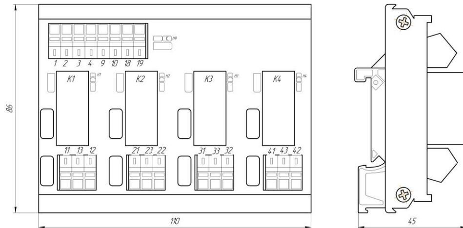
Рисунок 4.1 - Габаритные размеры блока усиления мощности БУМ-4
