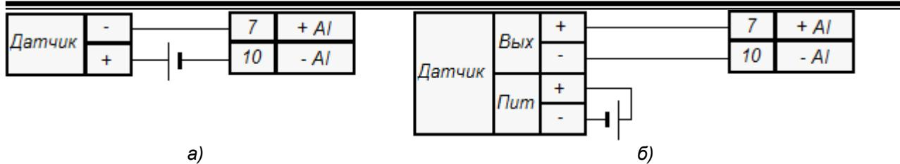
Рисунок 3.4 – схема подключения пассивного датчика:
