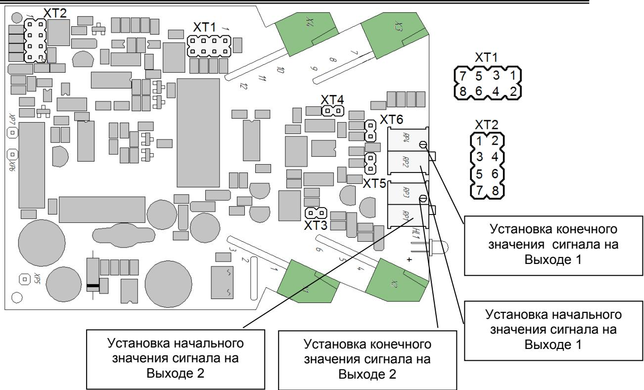
Рисунок 3.2 - Размещение блоков перемычек выбора выходных и выходных сигналов
