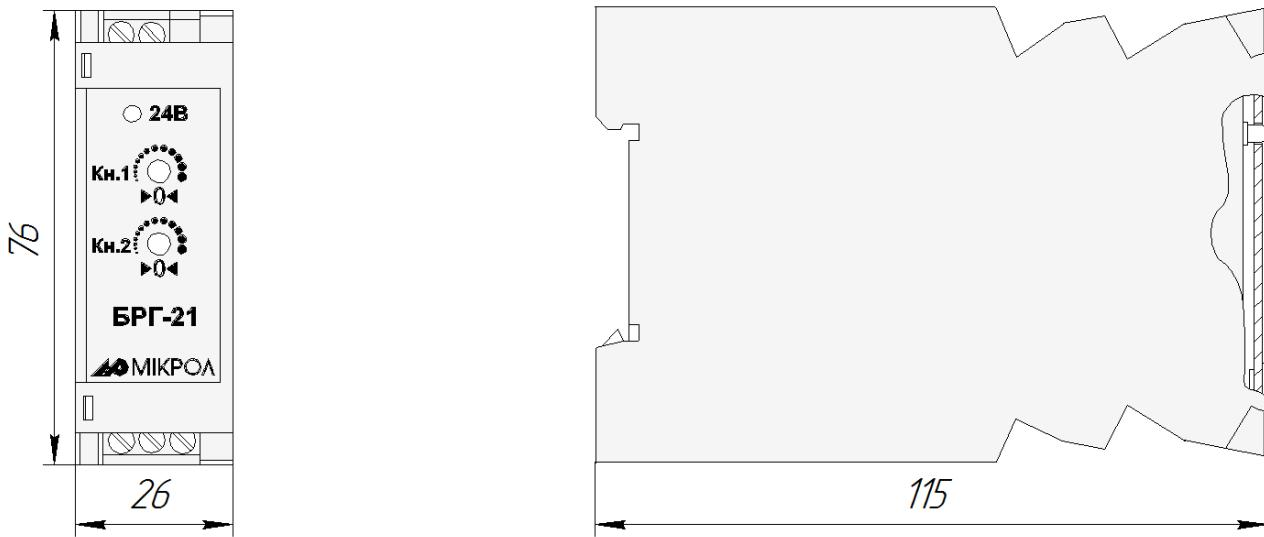
*Рисунок 1.1 – Двухканальный блок гальванической развязки аналоговых сигналов БРГ-21
