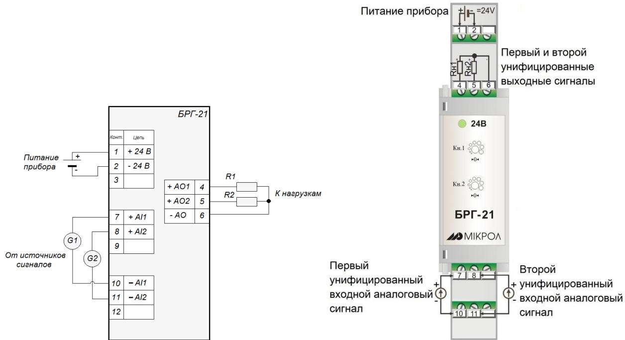
Рисунок 3.3 – Блок гальванической развязки аналоговых сигналов БРГ-21
