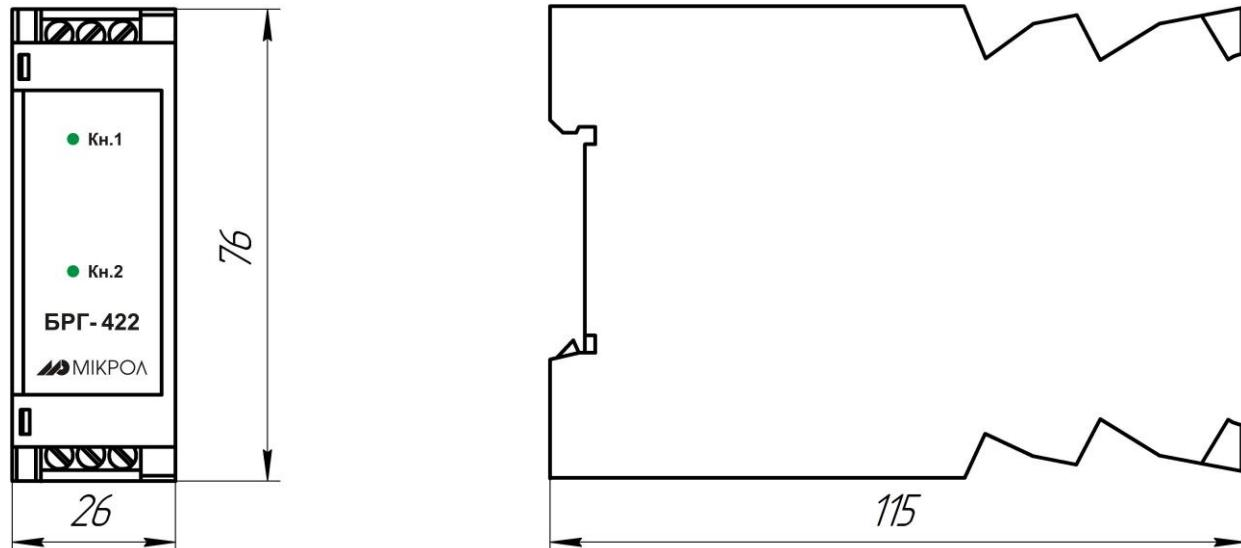
Рисунок 1.1 – Внешний вид и габаритные размеры БРГ-422
