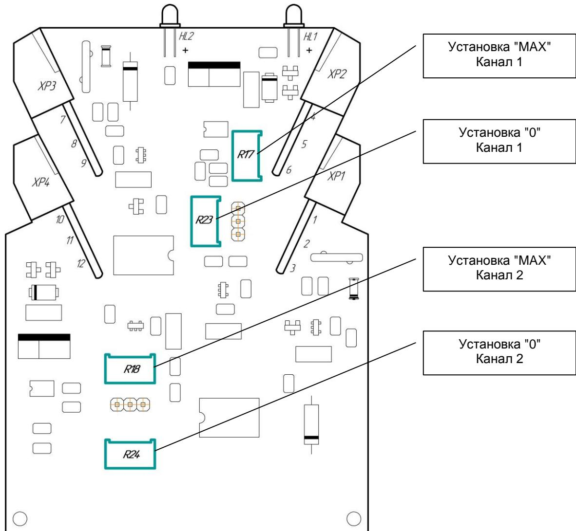
Рисунок 4.1 – Схема расположения элементов настройки БРГ-422
