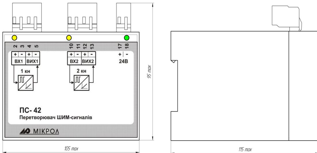
Рисунок 2.1 - Внешний вид и габаритные размеры ПС-42
