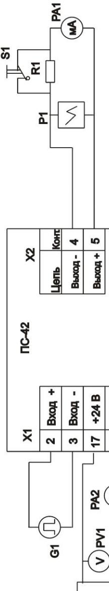
P1 - осциллограф, предел измерения от 1 до 200 мВ, входное сопротивление не менее 1 МОм, полосой пропускания до 1 МГц
