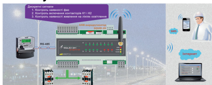
Рис. 2. Система керування одним об'єктом вуличного освітлення.
